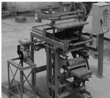
Foto 1 Máquina Bloquera-Adoquinera de accionamiento eléctrico o manual produce 400 piezas por 8 horas
