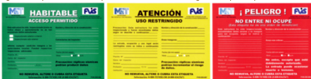
Figura 19. Etiquetas de FUNVISIS para identificar edificaciones luego de la inspección post-sísmica.
