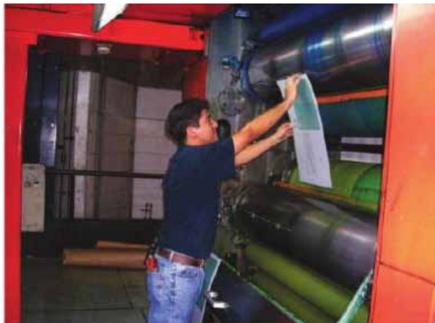
Figura 5. Disposición de planchetas de aluminio
