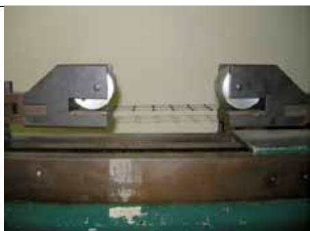
Figura 6 Malla de PP preparada para el ensayo
