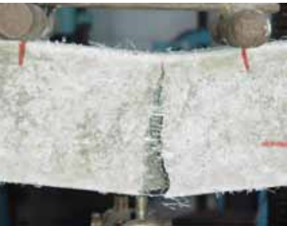
Foto 1. Ensayo de resistencia a la flexión
