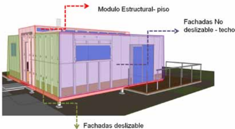
Figura 3. Componentes del módulo básico para un piso
