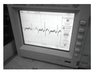
**Figura 13.** Prueba de visualización de la señal electrocardiográfica de voluntario 5
