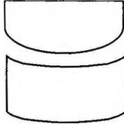
Pero al realizar la operación con tres cuerpos, puliendo alternadamente A contra B, B contra C y C contra A, entonces no puede formarse una superficie cóncava o convexa, sino sólo un plano. Este procedimiento es efectivamente usado en la industria óptica para la producción de planos de alta precisión. Lorenzen considera pues, como Hobbes y Spinoza, que las definiciones geométricas deben ser genéticas.
