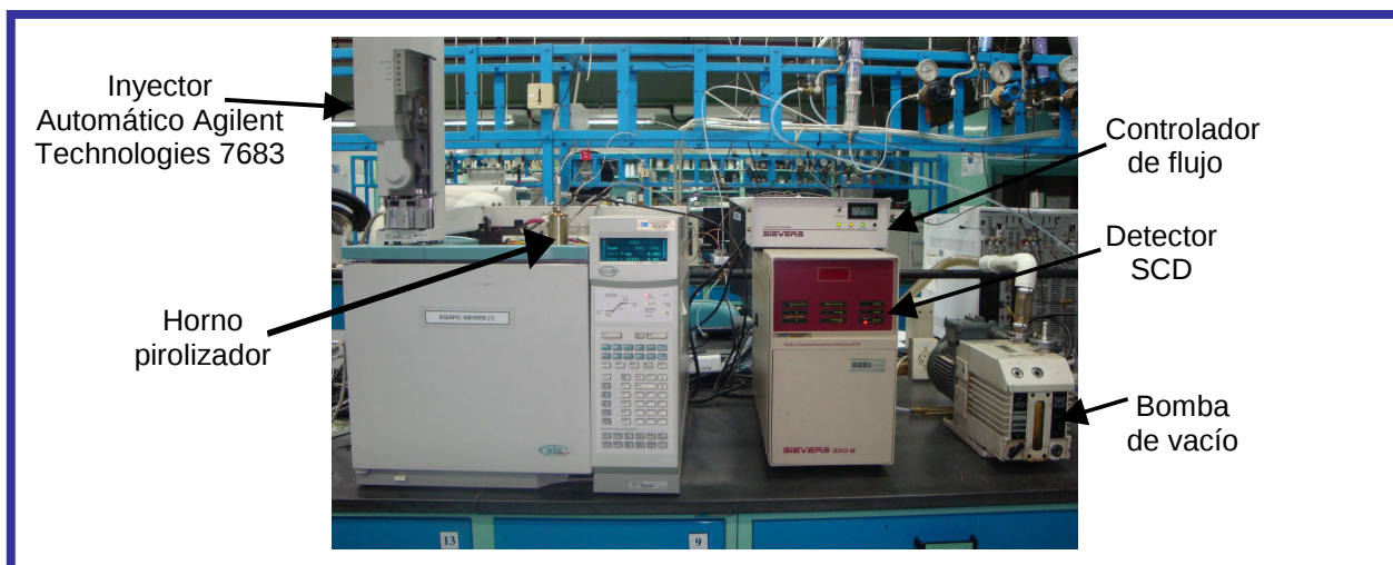
Figura 8. Cromatógrafo de gases Agilent Technologies modelo 6890 acoplado a un Detector de quimiluminiscencia de azufre Sievers 350 B.
