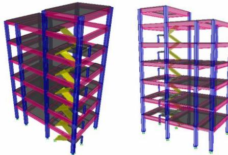
*Figura 44. Modelo en ETABS módulo C. fuente: elaboración propia, 2014.*
