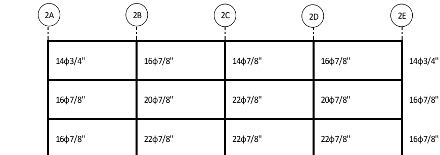
Figura 5.53: Refuerzo ajustado en columnas para cumplir la relación “1,40” del Procedimiento 2 en Pórtico 2.2. Fuente: Elaboración Propia
