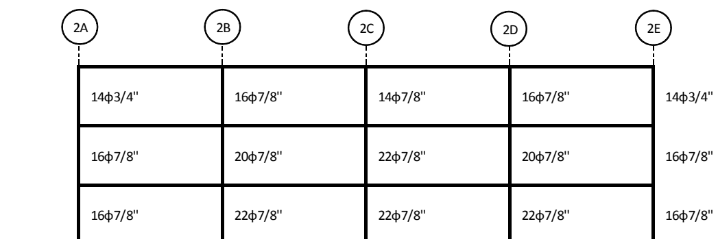
Figura 5.49: Refuerzo ajustado en columnas para cumplir la relación “2.30” del Procedimiento 1 en Pórtico 2.2. Fuente: Elaboración Propia.
