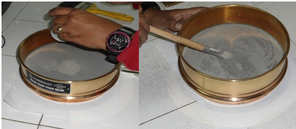
Figura 3.7 (izq.) Colocación del material sobre el tamiz #325 (der.) Distribución del material con un pincel sobre el tamiz #325 (Fuente propia)
