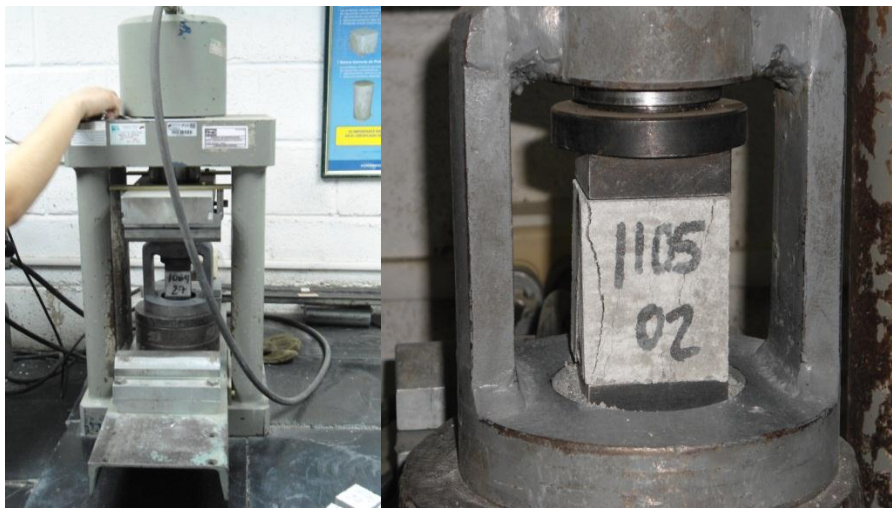
Figura 3.14 (izq.) Prensa para ensayos de compresión (der.) Falla de las probetas durante el ensayo de compresión (Fuente propia)
