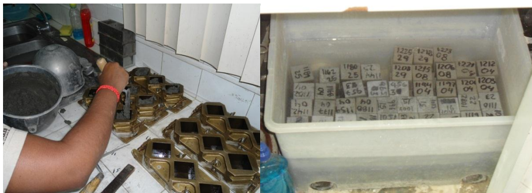
Figura 3.10 (izq.) Colocación del mortero en los moldes cúbicos (der.) Curado de las probetas cúbicas (Fuente propia)
