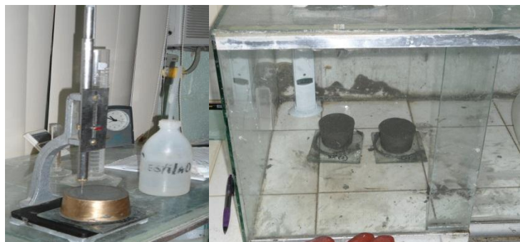
Figura 3.13 (izq.) Medición de la penetración con la aguja de Vicat (der.) Probetas de ensayo dentro de la cámara de humedad (Fuente propia)
