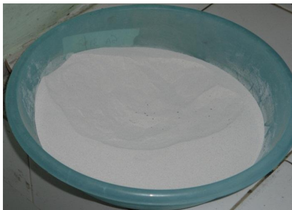
Figura 2.4 Catalizador gastado de craqueo catalítico CCF. (Fuente propia)
