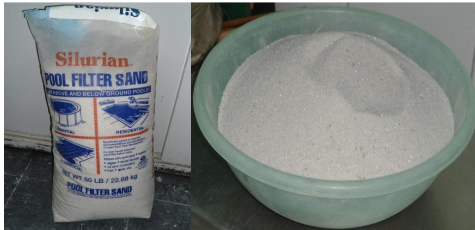
Figura 2.5 (izq.) Saco de arena de Ottawa (der.) Tara con arena de Ottawa. (Fuente propia)
