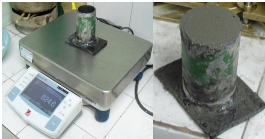
Figura 3.11 (izq.) Medición de la masa del molde (der.) Molde lleno de mortero (Fuente propia)
