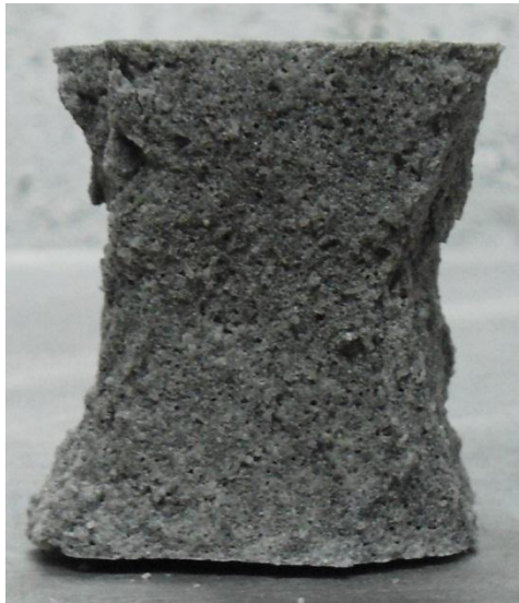
Figura 4.4 Falla a compresión. Rotura tipo doble pirámide (2) (Fuente propia)
