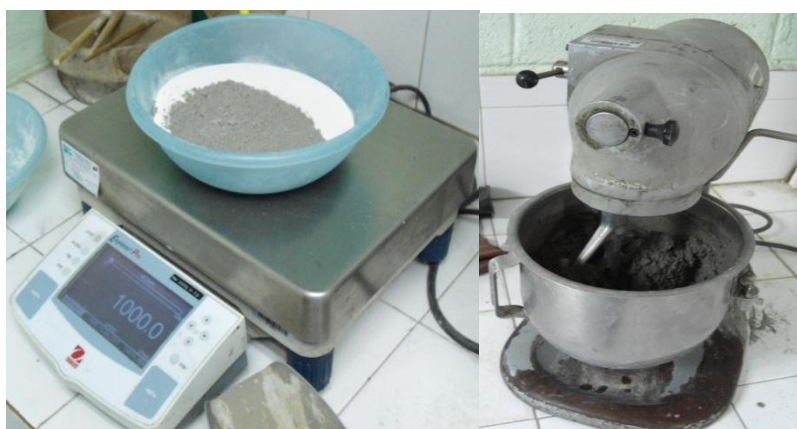
Figura 3.9 Medición de la masa del material en la balanza digital (der.) Mezclado de los materiales del mortero (Fuente propia)
