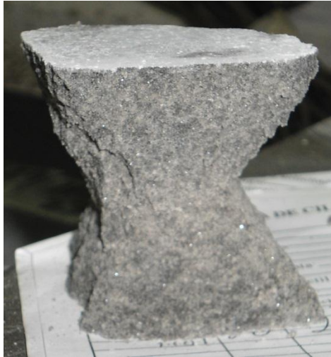
Figura 4.3 Falla a compresión. Rotura tipo doble pirámide (1) (Fuente propia)
