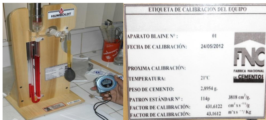
Figura 3.6 (izq.) Aparato de permeabilidad Blaine (der.) Etiqueta de calibración del aparato de permeabilidad Blaine (Fuente propia)
