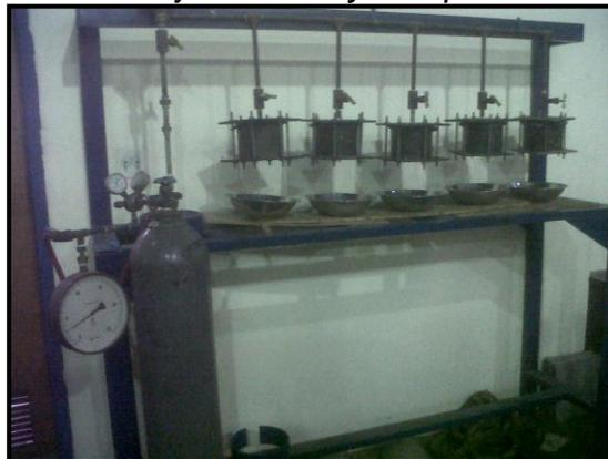
**Anexo 16:** Presión del ensayo de permeabilidad.
