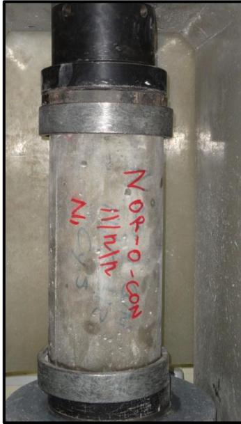
Fig. 3.18 Colocación de la probeta para ser comprimida.
