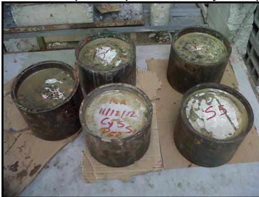
**Anexo 15:** Montaje del ensayo de permeabilidad.
