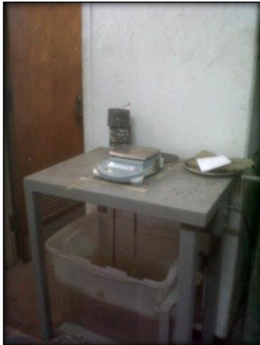
**Fig. 3.4** Secado de la superficie del agregado grueso para ensayo de peso específico de agregado grueso.
