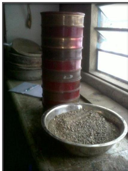
**Fig. 3.2** Tamizado Manual para agregado fino. Fuente: Propia.
