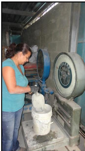
**Fig. 3.8** Pesado del cemento Portland tipo III. Fuente: Propia.
