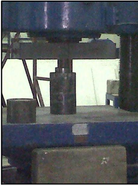
**Fig. 3.26** Extracción de los cilindros de concreto de los anillos de acero.
