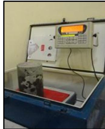
**Fig. 3.16** Pesado de las probetas en una balanza.
