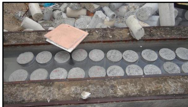
**Fig. 3.14** Colocación de las probetas en bañeras con agua y cal para su curado. Fuente: Propia.
