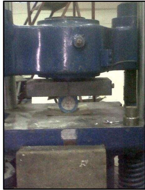
**Fig. 3.27** Ensayo de compresión indirecta o brasilero.
