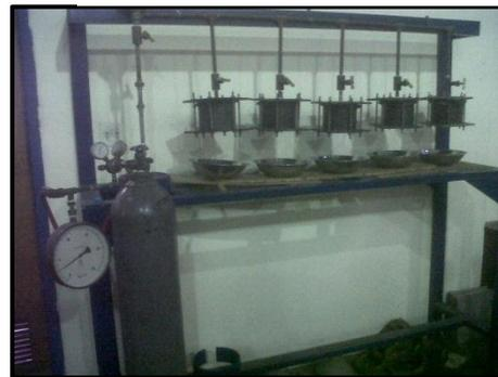
**Fig. 3.24** Montaje de las probetas de concreto para aplicarle la presión de agua. Fuente: Propia.
