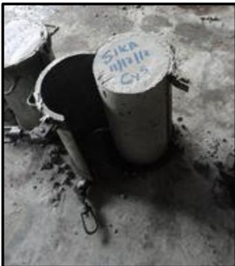
**Fig.3.13** Desmoldado de las probetas. Fuente: Propia.
