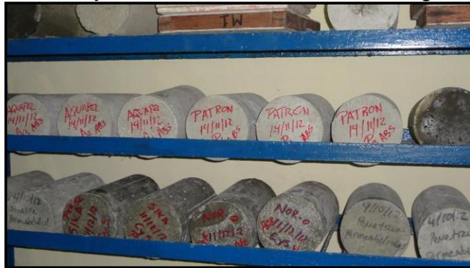
**Anexo 11:** Medición de los cilindros de concreto.
