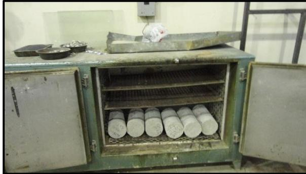
Fig. 3.17 Horno para secar las probetas de concreto durante 24 horas. Fuente: Propia.
