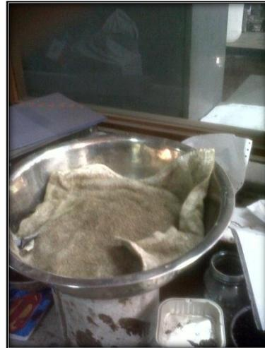
**Fig.3.6** Pesado de la muestra de agregado grueso sumergido en agua para ensayo de peso específico de agregado grueso. Fuente: Propia.
