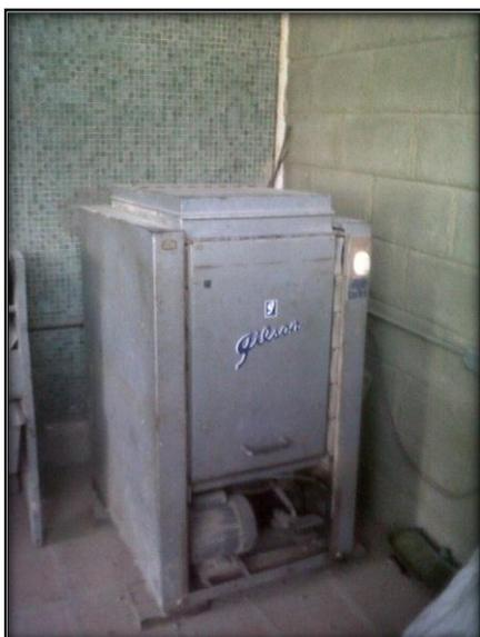
**Fig. 3.1** Tamizadora mecánica para agregado grueso. Fuente: Propia.
