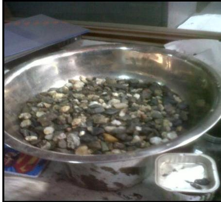
**Anexo 5:** Pesado del agregado grueso para el ensayo de peso específico.
