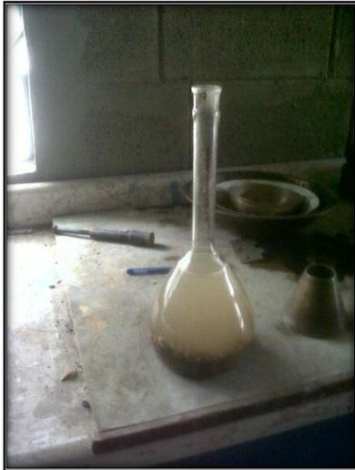
**Fig. 3.3** Pícnometro con la muestra sumergida para ensayo de peso específico de agregado fino.
