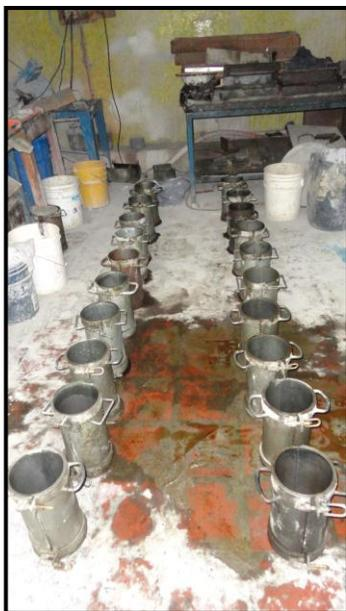
**Fig. 3.7** Preparación de los moldes, limpiándolos y colocándole una capa de aceite SAE 15w40. Fuente: Propia.
