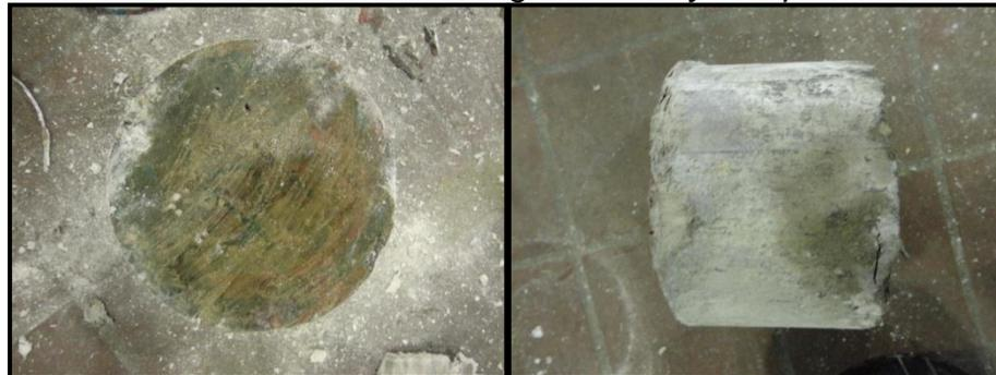
**Anexo 19:** *Ensayo a tracción indirecta.*
