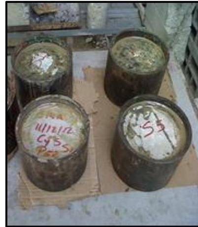
**Fig. 3.23** Probetas con epóxico las cuales se debieron retirar el exceso en ambas caras. Fuente: Propia.
