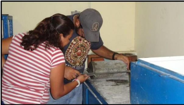
**Fig. 3.15** Medición de las probetas (altura y diámetro) con el uso de vernier de precisión.
