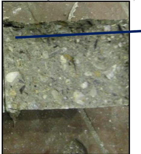
**Anexo 21:** *Fractura del concreto por penetración del agua.*
