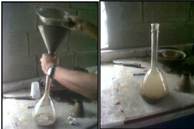
**Anexo 4:** Agregado grueso para el ensayo de peso específico.
