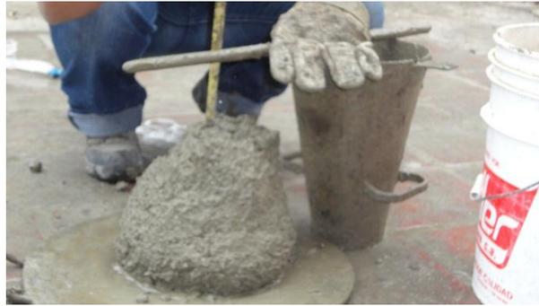
**Fig. 3.12** Medición del asentamiento de la muestra de concreto utilizando el Cono de Abrams. Fuente: Propia.
