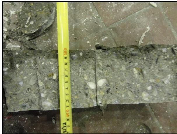
**Fig. 3.28** Medición de la penetración del agua en el cilindro de concreto aplicándole presión hidrostática.
