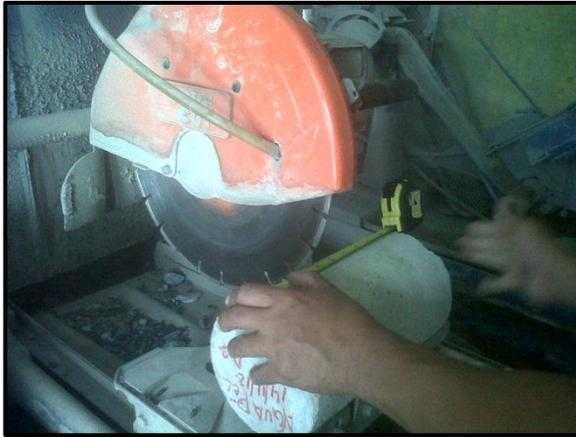
**Fig. 3.20** Sierra eléctrica para cortar las probetas. Fuente: Propia.
