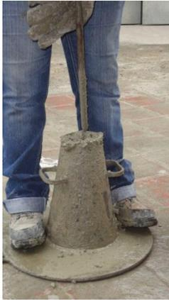
**Fig. 3.11** Compactación del Cono de Abrams con la barra lisa. Fuente:
