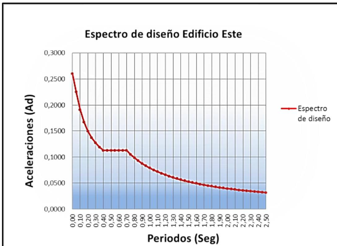
Figura 28. Espectro de diseño Edificio Este. EZ4S2AR6
