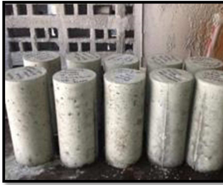
Figura 13. Probetas desencofradas. Fuente: Elaboración propia. Fecha: 08-Abr-2014
