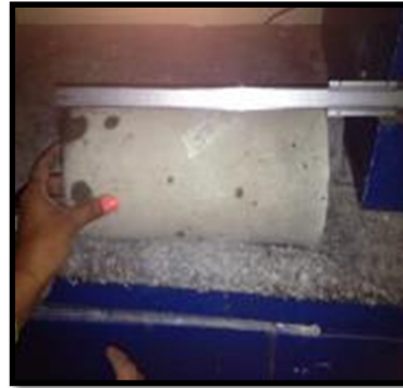
Figura 18. Medición de altura de la probeta con Vernier. Fuente: Elaboración propia. Fecha: 14-abr-2014
