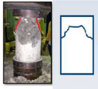
Falla N° 4. Mezcla sustitución 30% 7 días.
