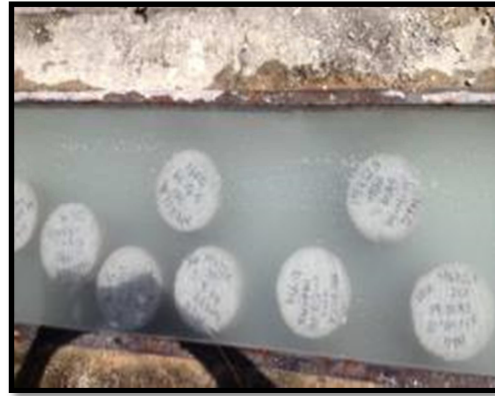
Figura 14. Probetas sumergidas en agua con adición de cal. Fuente: Elaboración propia. Fecha: 08-Abr-2014
