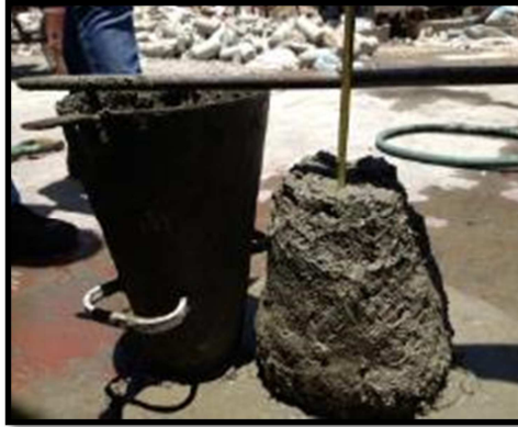
Figura 15. Medición del asentamiento. Fuente: Elaboración propia. Fecha: 07-Abr-2014
