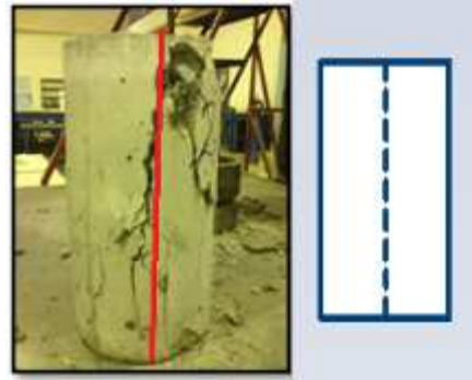
Falla N° 3. Mezcla sustitución 30 % 28 días.
