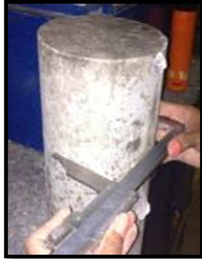
Figura 17. Medición de diámetro de la probeta con Vernier. Fuente: Elaboración propia. Fecha: 14-abr-2014
