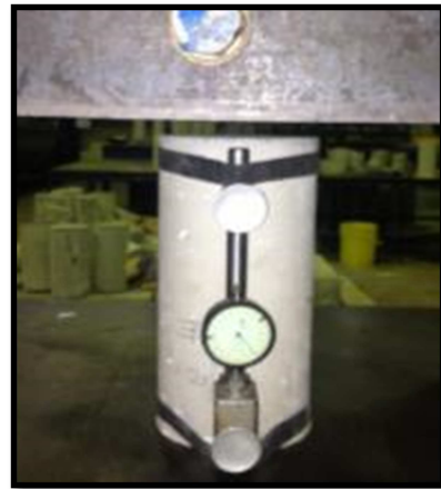
Figura 26. Extensómetro en cilindro. Fuente: Elaboración propia. Fecha: 12-May-2014
