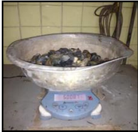
Figura 8. Muestra saturada con superficie seca en el aire. Fuente: Elaboración propia. Fecha: 25-Mar-2014
