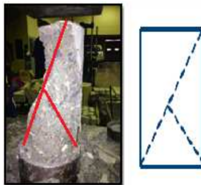
Falla N° 7. Mezcla sustitución 40 % 28 días.
