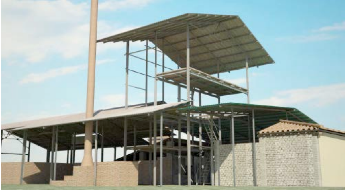
Imagen 5: Trapiche Santa Rita. Vista tridimensional de la estructura de las mezzaninas.
