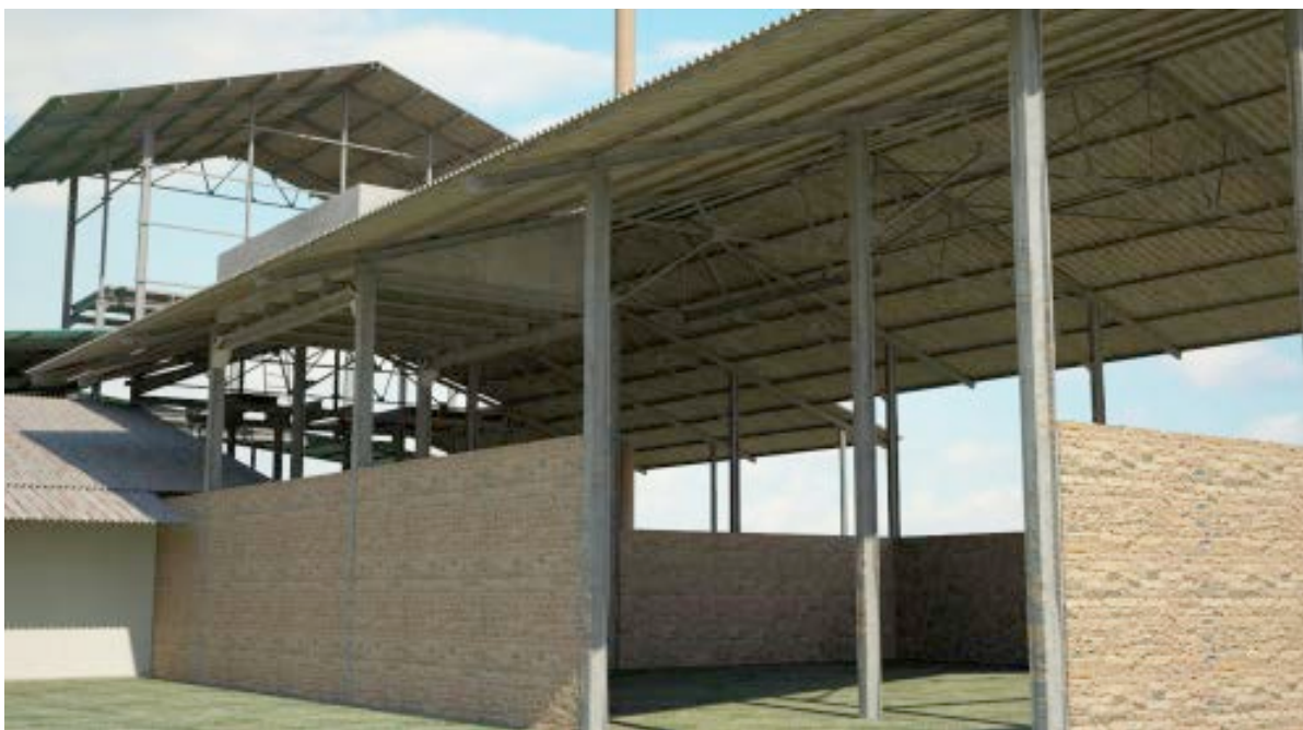
Imagen 3: Trapiche Santa Rita. Vista tridimensional de la estructura del cuerpo norte.
