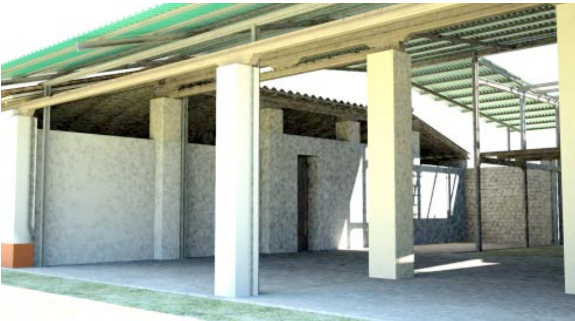
Imagen 2: Trapiche Santa Rita. Vista tridimensional de la estructura de techo del cuerpo sur.
