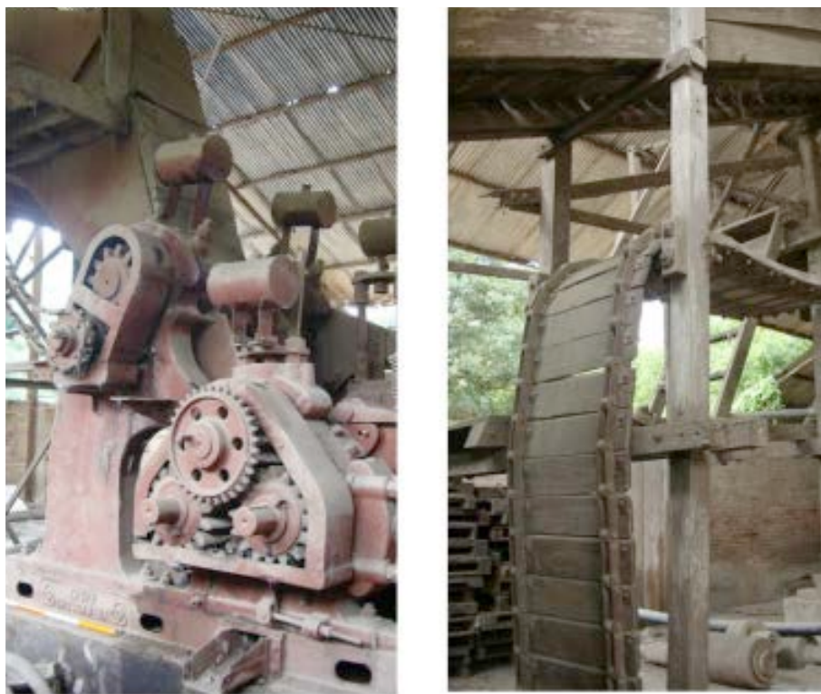
Fotografía 16: Trapiche Santa Rita. Izquierda: Tándem de mazas marca Krupp; derecha: correa transportadora de caña de azúcar.
