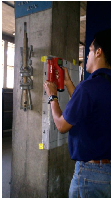
Figura IV.2.2.1: Medición de columnas con el Ferroskan. Fuente propia.
