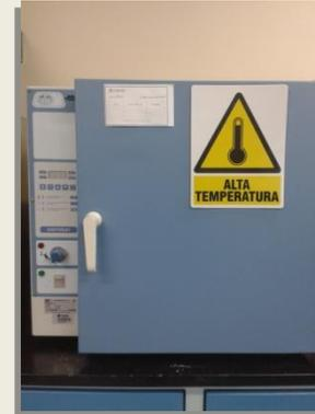
Figura 19. Estufa por convección Selecta, modelo Digitronic 2000.
