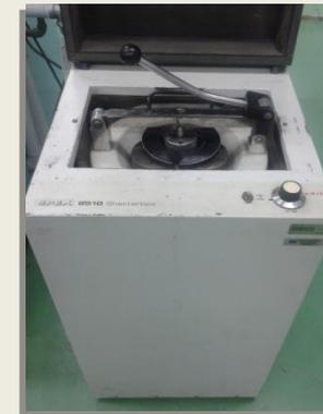
Figura 21. Molino Spex, Modelo 8510.
