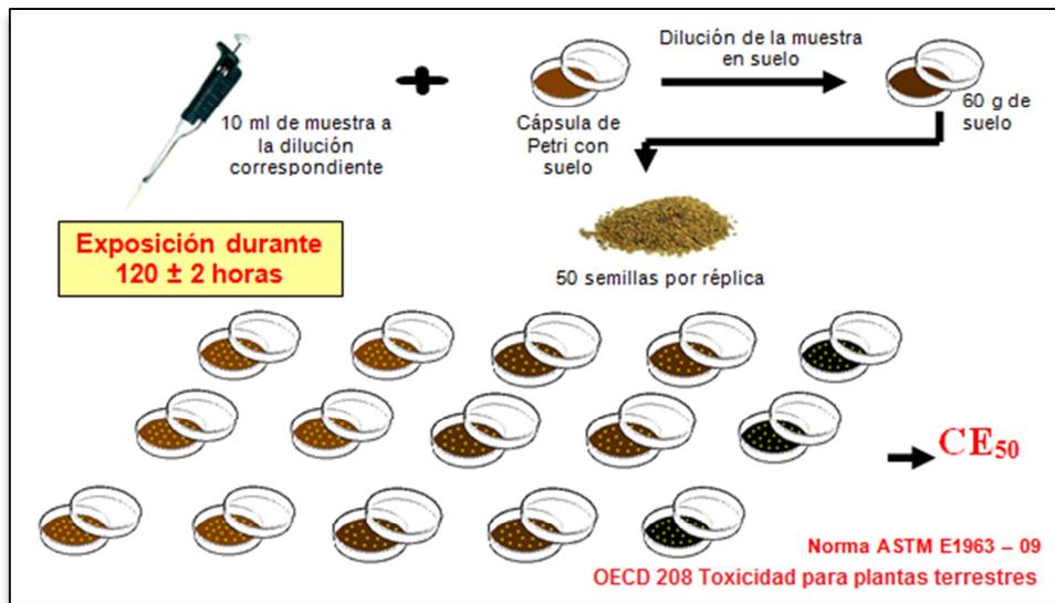
Figura 26. Método empleado en el ensayo de toxicidad con las semillas de alfalfa Fuente: (Hernández y Pereira, 2010)
