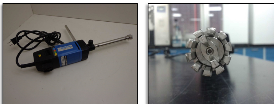
Figura 20. Mezclador homogeneizador Janke Kunkel Fuente: Elaboración propia
