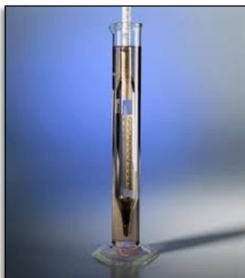
Figura 22. Hidrómetro Fuente: Elaboración propia
