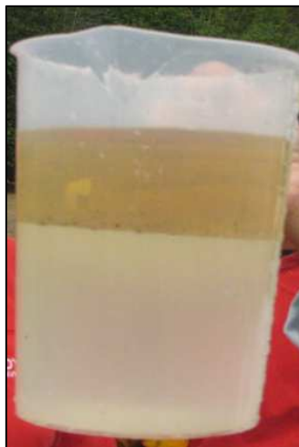
Figura 38. Mezcla de extinción con AFFF 6% Fuente: Elaboración propia
