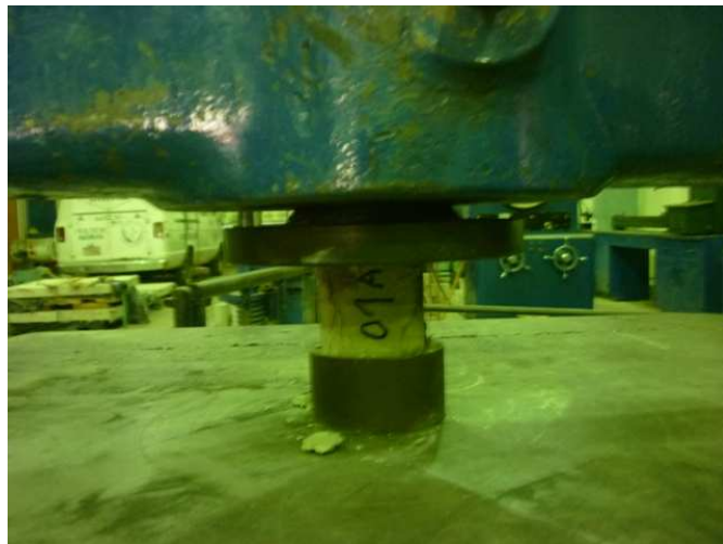
Figura 6. Probeta hecha con arena amarilla convencional en molde normativo ensayada a compresión.
