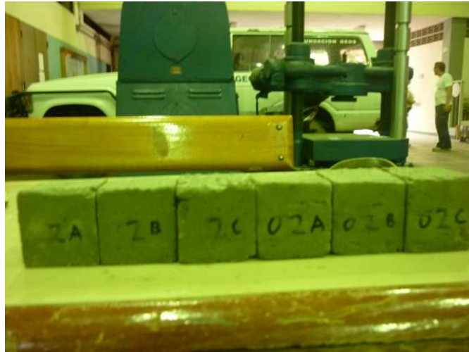
Figura 6. Probeta hecha con arena amarilla convencional en molde normativo ensayada a compresión.
