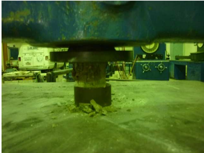
Figura 8. Probeta hecha con arena producto de la extracción de Níquel en molde normativo ensayada a compresión.
