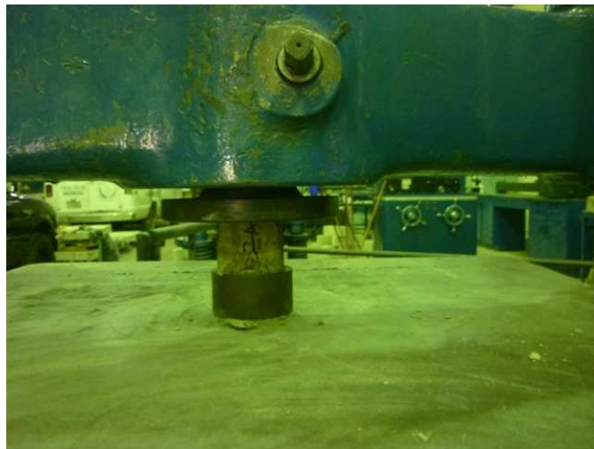
Figura 8. Probeta hecha con arena producto de la extracción de Níquel en molde normativo ensayada a compresión.
