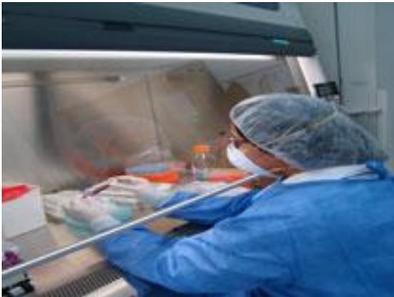
Se ubicara todo el material a utilizar en el interior de la cabina antes de empezar a trabajar, situando al material contaminado en un extremo de la superficie del trabajo y el no contaminado en el extremo opuesto de la misma. Es recomendable que el material a introducir en la cabina esta libre de partículas, por ello debería limpiarse cuidadosamente antes de su introducción en la misma.
