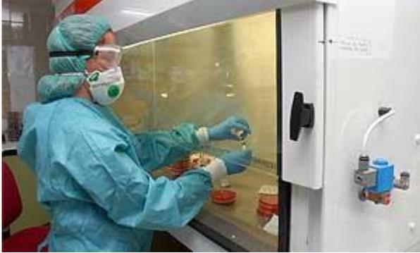
La protección del trabajador viene dada por la creación de una barrera de aire formada por la entrada de aire desde el local, a través de la abertura frontal y por el mencionado flujo descendente de aire filtrado estéril.
