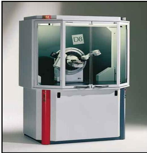
Figura 16. Equipo de DRX, marca Siemens, modelo AXS Bruker D8 advance
