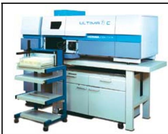
Figura 14. Equipo de EEO-IAP, Horiba Jobin – Ybon Modelo ULTIMA 2
