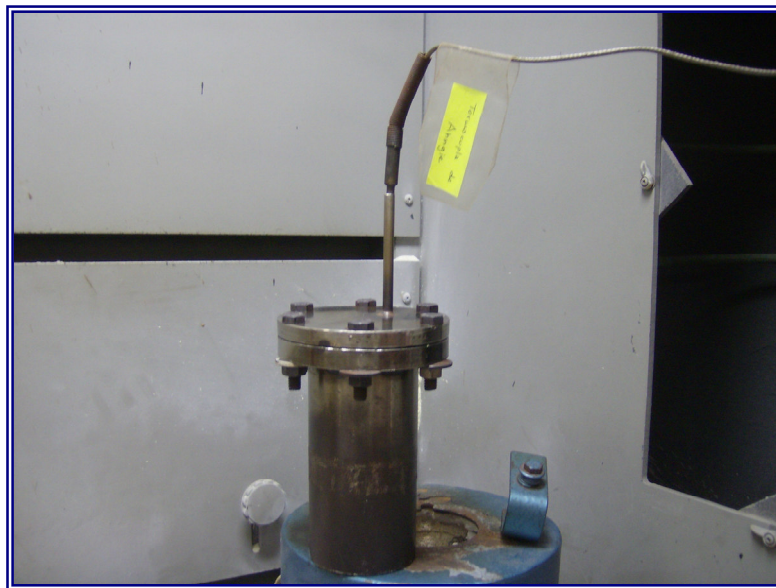
Figura 5: Reactor de acero inoxidable utilizado para los ensayos de hidropirólisis
