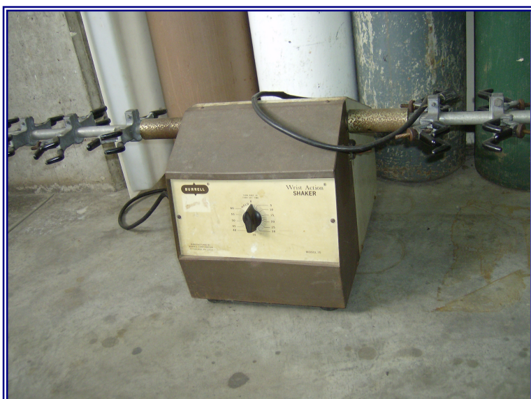
Figura 6: Equipo Shaker utilizado para agitar las muestras de adsorción
