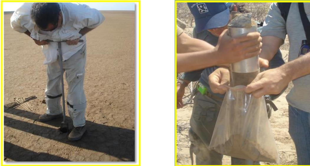
Figura 16. Muestreo de sedimentos superficiales empleando barreno
