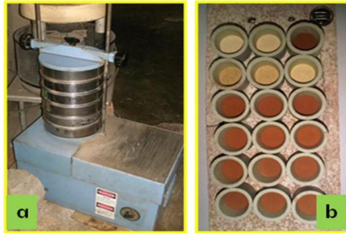
Figura 20. Fotografías de la metodología experimental. a) Tamizadora automática empleada en el proceso de tamizado en seco. b) Muestras de sedimentos luego de la determinación de pérdida al rojo
