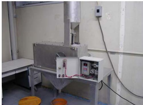
**Figura 2.14 (c)** Máquina de Ensayo, Panel de control con Temporizador.
