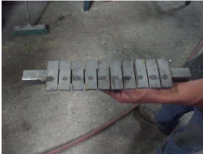
**Figura 2.1** Distribución de las muestras en el porta-probetas.
