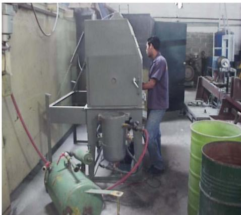
Para darle la rugosidad adecuada a las muestras, éstas fueron atacadas, utilizando partículas de óxido de aluminio a una presión de 90 Psi y una distancia de 20-25cm y durante 1 minuto aproximadamente. Esta operación se llevó a cabo dentro de una cámara de Blasting. (ver **Figura 2.3**)
