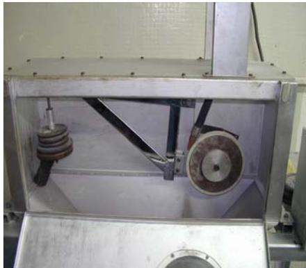
**Figura 2.14 (b)** Sistema brazo multiplicador con pesos.
