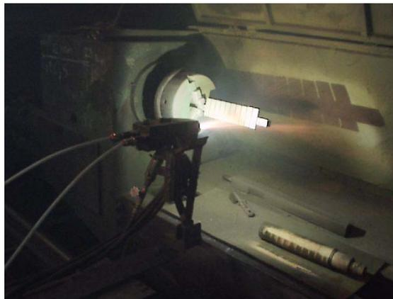
**Figura 1.9** Proceso de rociado térmico por Arco Eléctrico.
