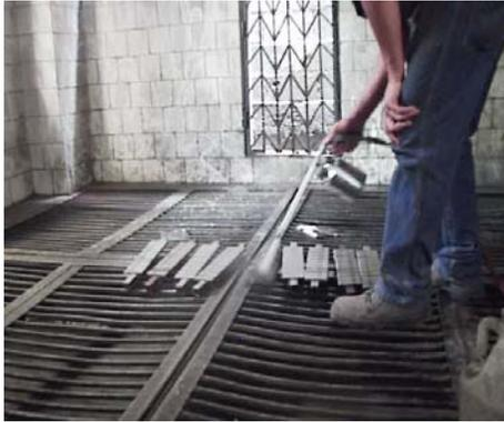
La superficie de la pieza de trabajo, se limpió con Tinner para remover la grasa o cualquier otro contaminante que pudiera impedir la adhesión del recubrimiento al sustrato. (Ver **Figura 2.2**)
