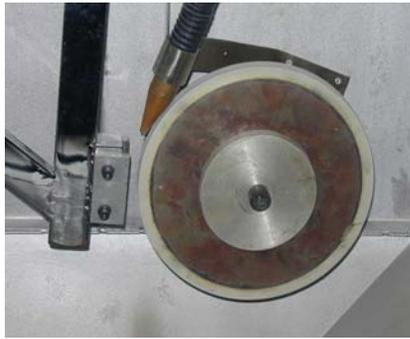
**Figura 2.14 (a)** Porta-probetas, Rueda de Caucho y Tobera de Abrasivo.
