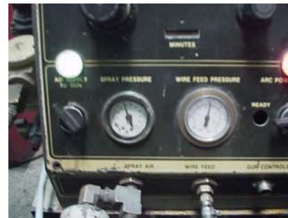
La **Figura 2.7** muestra el proceso de deposición realizado en la Planta PLASMATEC, Ingenieros S.A., con un equipo de arco eléctrico semi-automatizado el cual asegura que todos los procesos mantengan constantes la distancia y velocidad de desplazamiento de la pistola.
