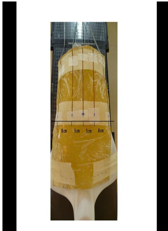
*Fig. 3.11. Detectores MOSFET colocados sobre el maniquí (1 arco, 1 isocentro).*
