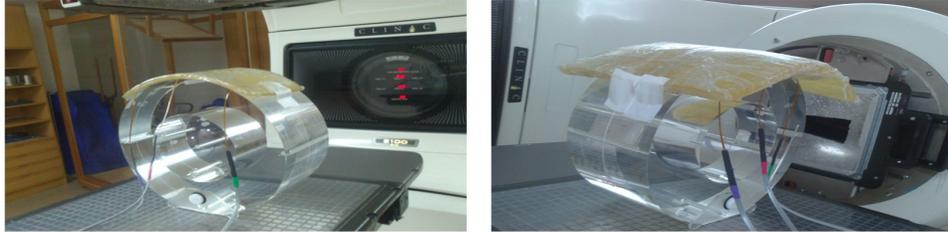
*Fig. 3.10. Irradiación del maniquí cilíndrico con bolus de 1 cm para la energía de 6 MeV (Izq) y con bolus de 1,5 cm para la energía de 9 MeV (Der).*
