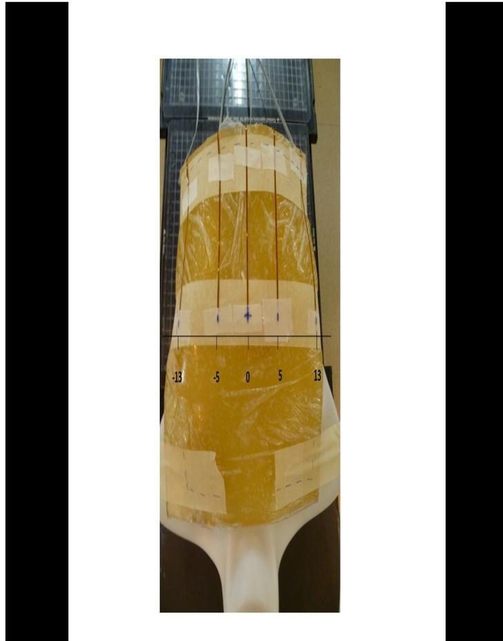
*Figura 4.1. Posición de los detectores MOSFET en la superficie del maniquí. Técnica de isocentro único.*
