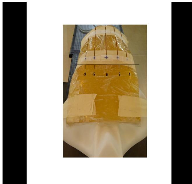
*Figura 4.8. Posición de los detectores MOSFET en la superficie del maniquí. Técnica de tres isocentros.*
