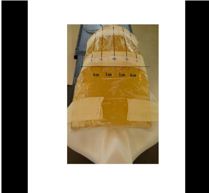
*Fig. 3.18. Detectores MOSFET colocados sobre el maniquí (3 arcos, 3 isocentros).*
