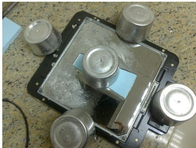
*Fig. 3.2. Vaciado del cerrobend para formar el aplicador trapezoidal.*
