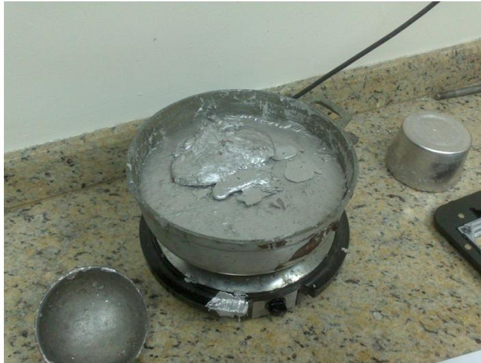
*Fig. 3.1. Fundición del cerrobend.*
