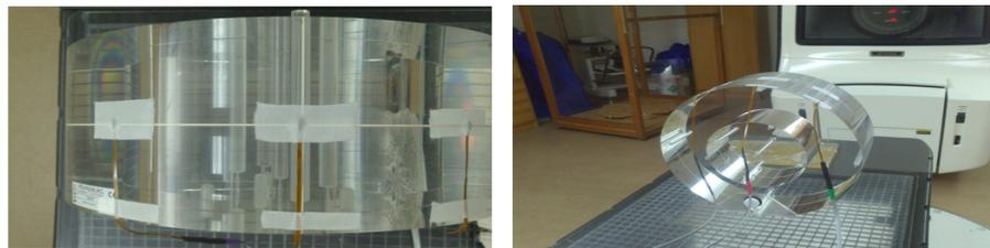
*Fig. 3.9. Maniquí cilíndrico con los detectores MOSFET*
