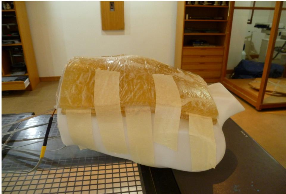
*Figura 3.15. Irradiación del maniquí con bolus de 1,5 cm sobre los MOSFET.*
