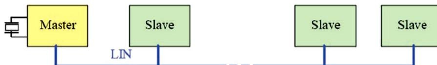
Figura 7.5: Interconexión de un Maestro LIN con varios Esclavos LIN
