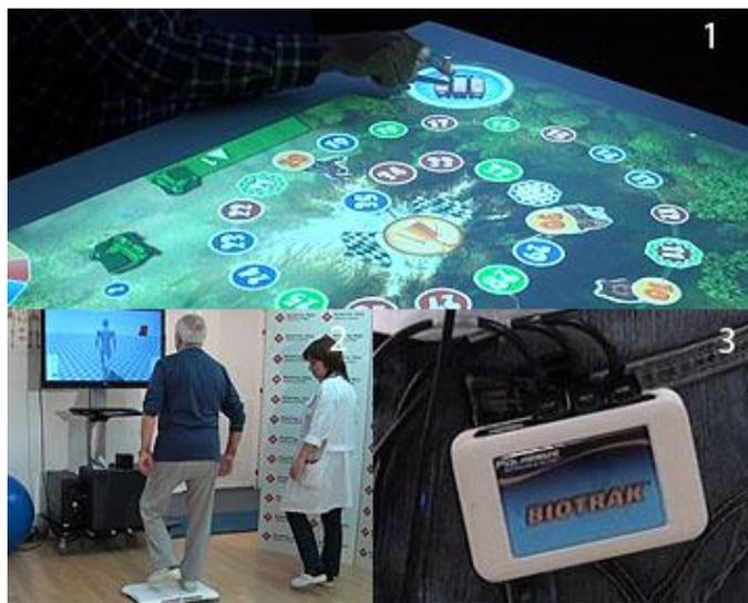
Figura 8: Sistema BioTrak (1) Pantalla multitáctil. (2) Plataforma de presión. (3) Tracker magnético.
