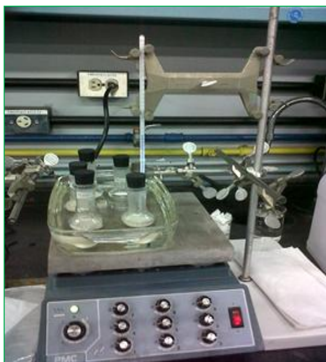
Figura 42. Montaje experimental para la determinación de la conductividad de los sistemas metacaolín- \text{Ca(OH)}_2
