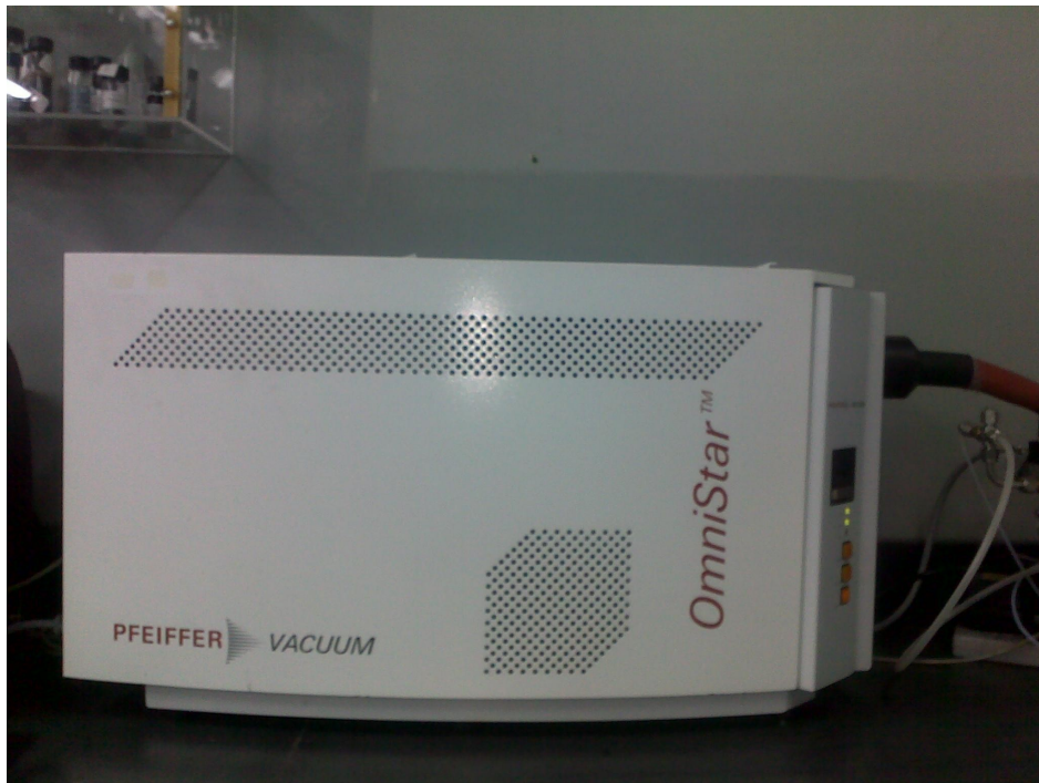
Figura 12: Cuadrupolo de masas, marca Pfeiffer Vacuum, modelo Omnistar
