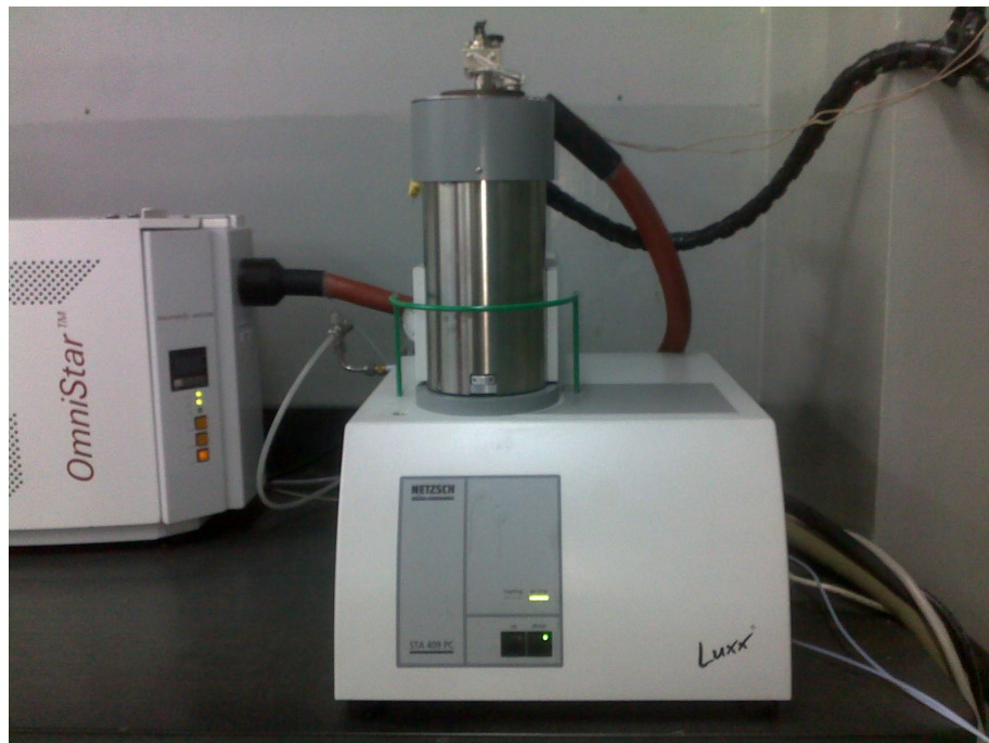
Figura 10: Termobalanza marca Netzsch, modelo STA 409PC/4/H/CO Luxx
