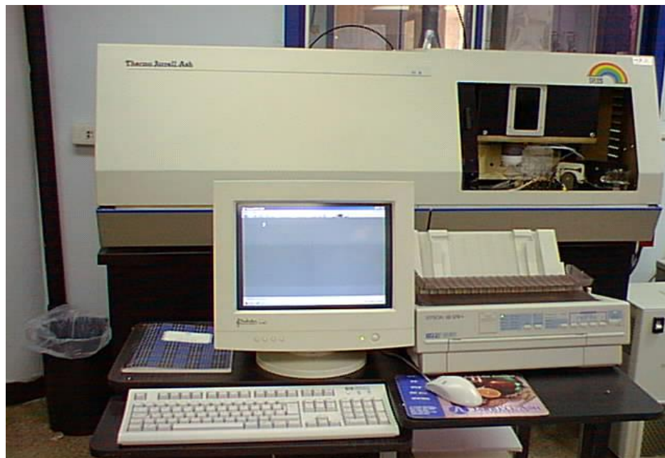
Figura 12. Espectrómetro de emisión atómica con fuente de plasma de argón, inductivamente acoplado, marca Thermo Jarrell Ash, modelo IRIS.
