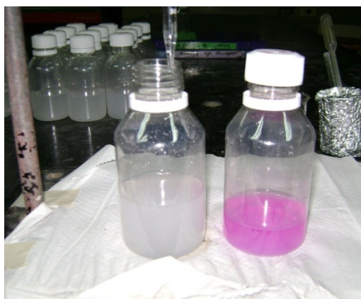
Fig. 17. Respirometría. Soluciones antes de la titulación (color púrpura) y después de la titulación (sin color)
