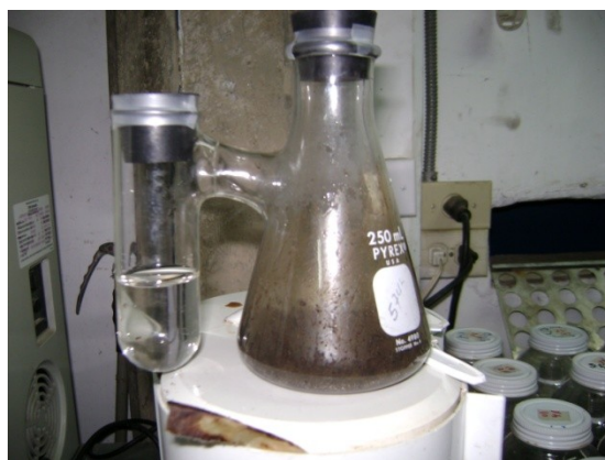
Fig. 16. Frascos tipo Warburg, donde se muestra la disposición de la muestra de suelo y la trampa de CO 2 en un tubo adherido a un costado de la fiola de 250 ml
