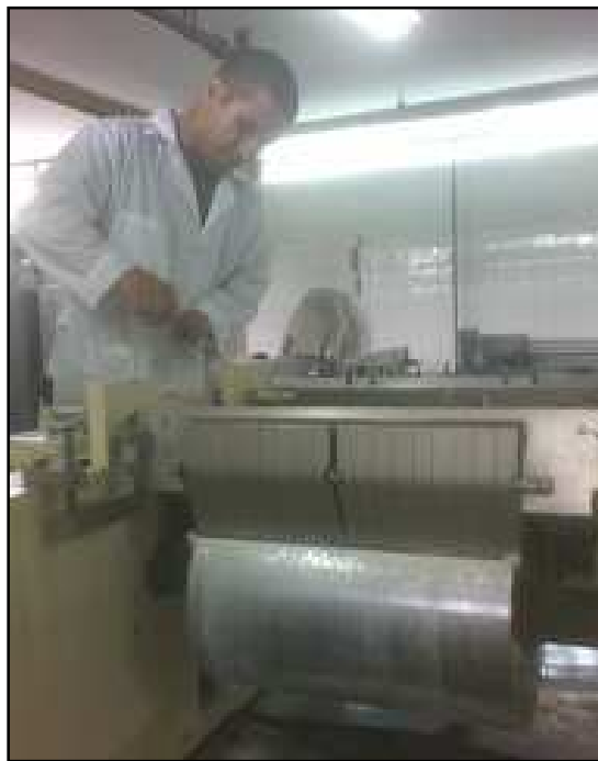
PROCESO DE PREGELATINIZACION DE LA HARINA EN DESHIDRATADOR DE DOBLE TAMBOR
