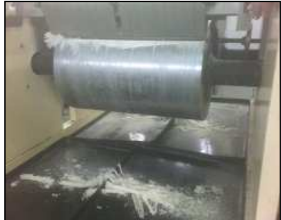
PROCESO DE PREGELATINIZACION DE LA HARINA EN DESHIDRATADOR DE DOBLE TAMBOR
