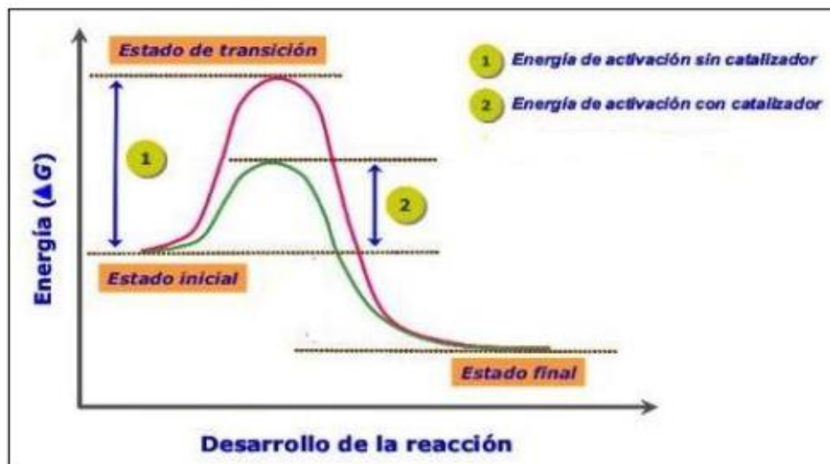
Figura N° 1 Diagrama de energía de una reacción catalizada y sin catalizar.
