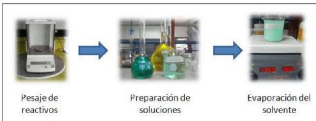
Figura N° 6 Esquema de síntesis de sólidos metal-orgánico
