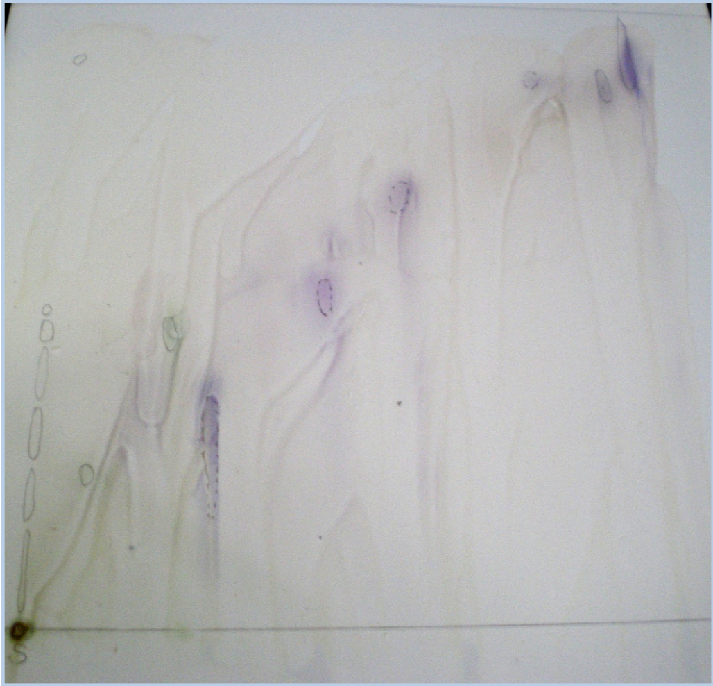
Figura 34. CCF en 2D del extracto de Cloroformo de la especie susceptible con una primera fase móvil: cloroformo y una segunda fase móvil: 8:2 Cloroformo/Hexano y revelador: p-anisaldehído.
