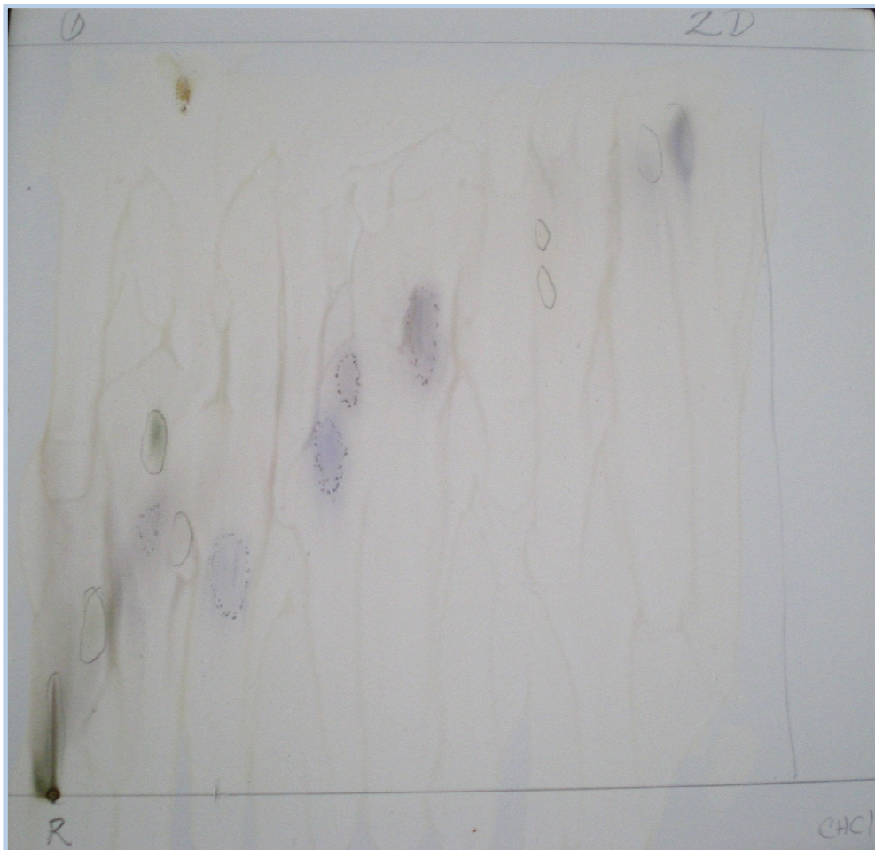
Figura 33. CCF en 2D del extracto de Cloroformo de la especie resistente con una primera fase móvil: cloroformo y una segunda fase móvil: 8:2 Cloroformo/Hexano y revelador: p-anisaldehído.
