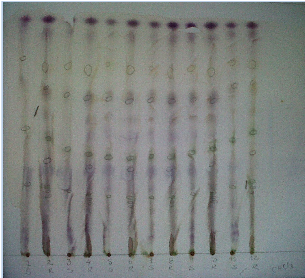
Figura 29. CCF comparativo de los extractos de Cloroformo de la especie resistente y susceptible, con una fase móvil: Cloroformo y revelador: p-anisaldehído.
