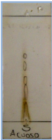
Figura 24. CCF del extracto Acuoso de la especie susceptible, con una fase móvil: 9:1 Acetato de Etilo/Metanol y revelador: p-anisaldehído.
