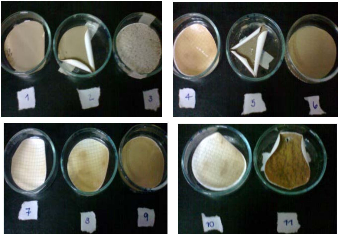
Figura 23 Sólidos suspendidos en la membrana Millipore de 0,45 \mu\text{m} .
