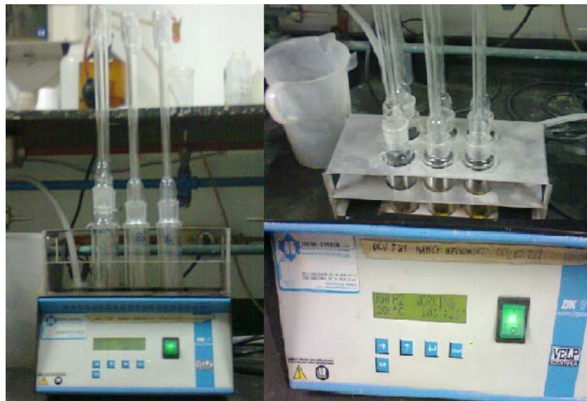
Figura 27 Proceso de digestión de las muestras en el equipo digestor marca Velp Scientifica, modelo DK6
