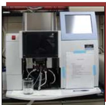
**Imagen 4:** Espectrofotómetro de absorción y emisión atómica con llama Perkin Elmer AAnalyst200.
