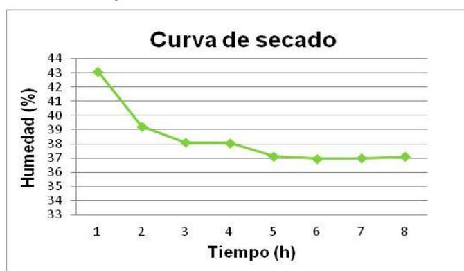
Figura 14. Curva de secado de láminas flexibles de arazá de 30 °Brix, deshidratadas a 60 °C.
