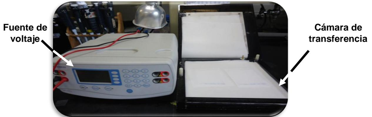
**Figura 12:** Representación fotográfica del sistema de electrotransferencia empleando una cámara semiseca.
