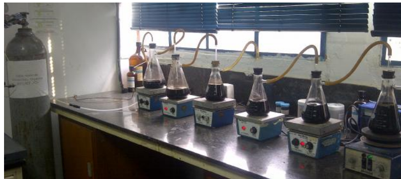
Figura 17. Sistema de extracción de sustancias húmicas, con atmósfera inerte
