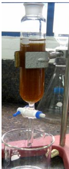
Figura 20. Purificación de los ácidos fúlvicos con la resina Amberlita IR-120
