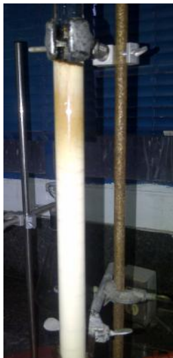
Figura 19. Purificación de ácidos fúlvicos con la resina Amberlita XAD-8
