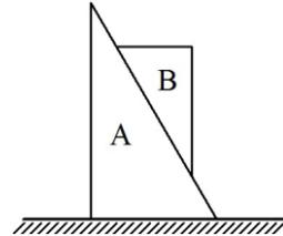
21.- La cuña A de masa  $m$  se mueve en la superficie horizontal lisa fija a tierra. La cuña B de masa  $2m$  se mueve en la superficie de la cuña A, inclinada  $45^\circ$  con la horizontal. Si el coeficiente de roce estático entre las cuñas es  $0,5$ ; determinar el valor máximo y el valor mínimo de la fuerza horizontal  $\bar{F}$  que se debe aplicar a la cuña A hacia la derecha, para evitar el deslizamiento entre ellas.
