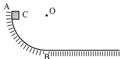
46.- La cinta transportadora superior descarga bloques de dimensiones despreciables y peso  $P$  sobre la rampa inclinada fija a tierra con velocidad de magnitud constante igual a  $9\text{ m/s}$ . Si el coeficiente de roce entre los bloques y la rampa es  $0,3$ ; determinar la inclinación de la misma con la horizontal, para que los bloques se transfieran sin deslizar sobre la cinta transportadora inferior, que se mueve con velocidad de magnitud constante igual a  $3\text{ m/s}$ .
