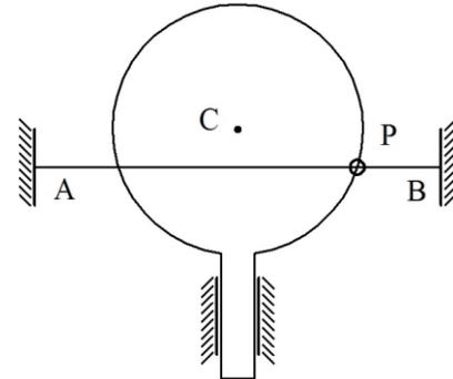
35.- El perno P de masa m se mueve en el semiarco AC liso de centro O y radio R fijo a tierra, y simultáneamente en la barra AB también lisa, articulada a tierra en A. La ley de movimiento del perno respecto a tierra es:
