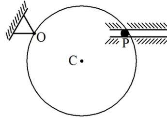
34.- El anillo P de masa m se mueve en el alambre horizontal AB liso y fijo a tierra, y simultáneamente en el aro de centro C y radio R también liso, que se desplaza verticalmente hacia abajo con velocidad de magnitud constante v; determinar las reacciones sobre el anillo para el instante en el cual el centro C del aro se encuentra sobre la recta AB
