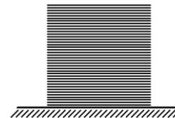
60.- La barra AB de longitud L, sección transversal despreciable y peso P descansa en la superficie horizontal fija a tierra. Si la reacción normal que genera la superficie sobre la barra se distribuye uniformemente a lo largo de ella y el coeficiente de roce es  $\mu$ ; determinar la magnitud de la máxima fuerza horizontal F, perpendicular al eje longitudinal de la barra y aplicada en su extremo derecho que garantiza su equilibrio.
