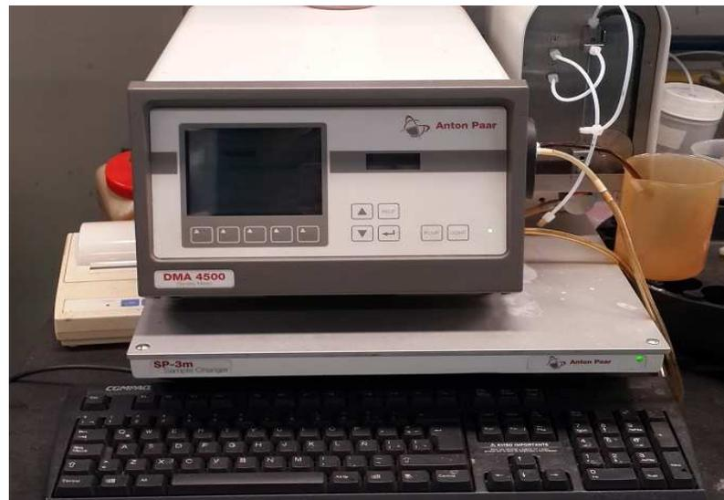
Figura 4.4. Densímetro DMA-4500
