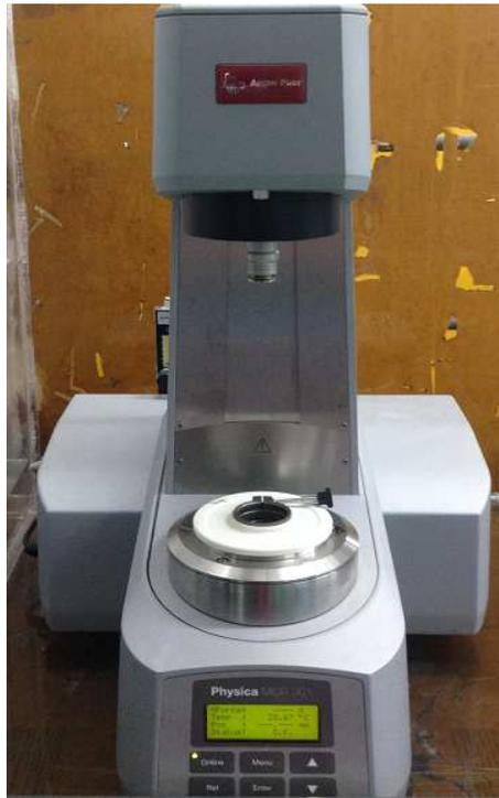
Figura 4.2. Reómetro Anton Paar MCR-301
