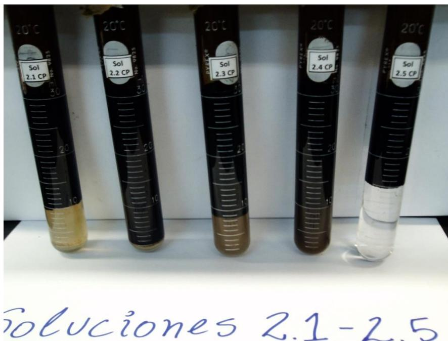
Figura 5.7. Comportamiento de fase de los sistemas crudo/ agua/ NaOH/ AMPS.
