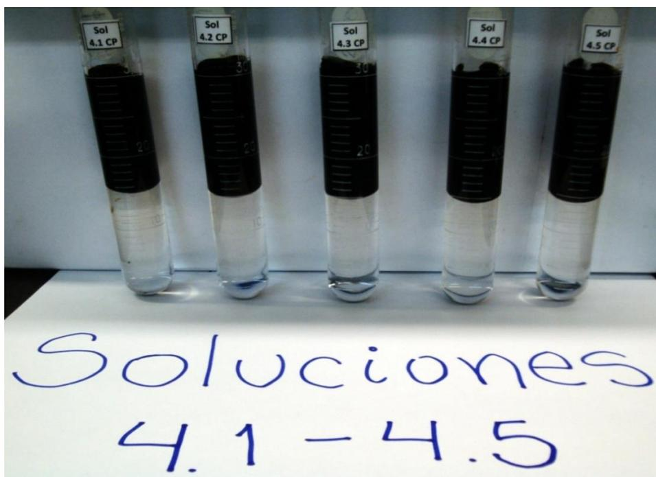
Figura 5.9. Comportamiento de fase de los sistemas crudo/ agua/ Alcanolamina/ HPAM
