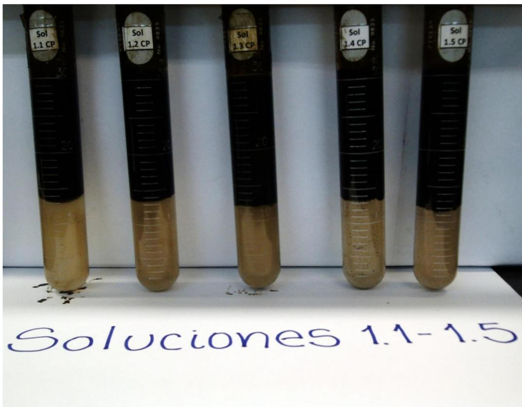
Figura 5.6. Pruebas de comportamiento de fase a 60°C de los sistemas crudo-agua-alcanolamina-AMPS
