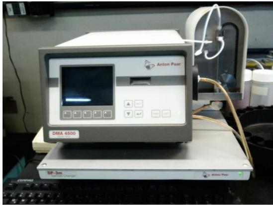
Figura 4.3. Densímetro DMA-4500
