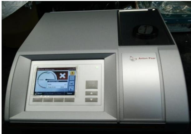
Figura. 4.4 Refractómetro Abbemat 300.
