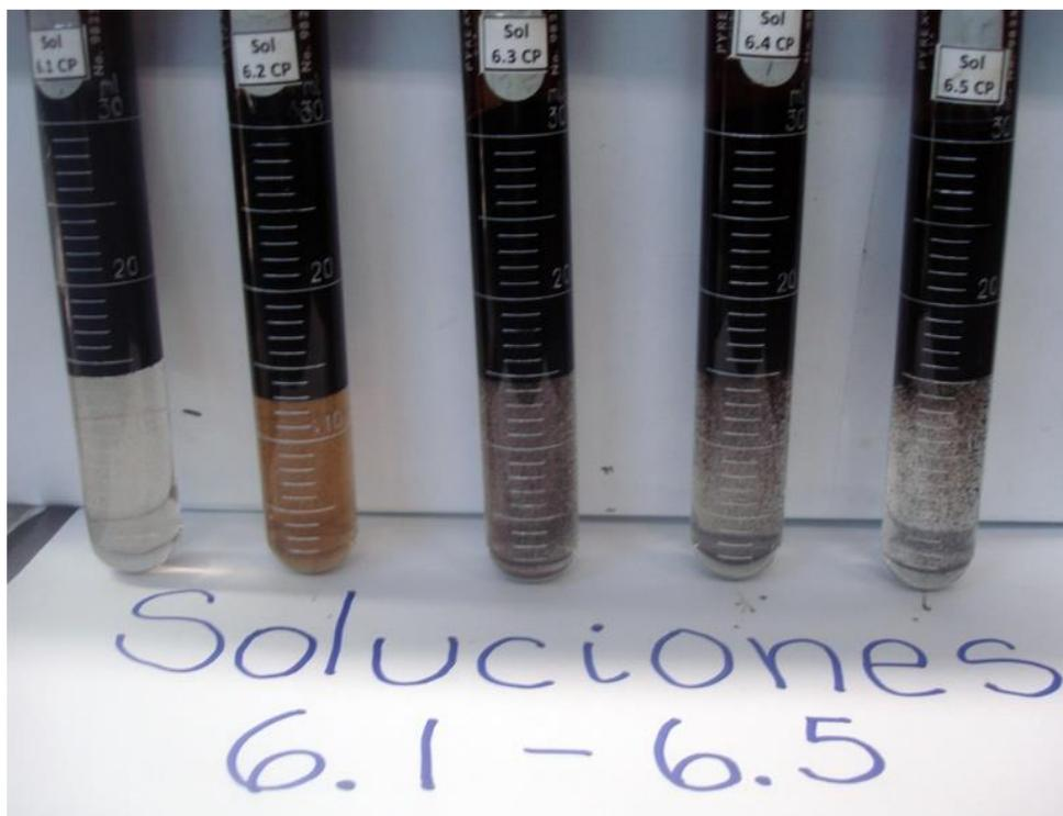
Figura 5.11. Comportamiento de fase de los sistemas crudo/ agua/  $\text{Na}_2\text{CO}_3$ / HPAM.
