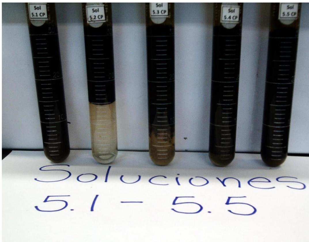
Figura 5.10. Comportamiento de fase de los sistemas crudo/ agua/ NaOH/ HPAM.
