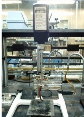
Figura 4.2. Mezclador Eléctrico de propela Caframo modelo DHL
