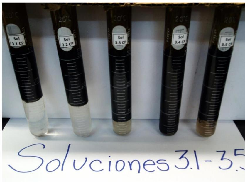
Figura 5.8. Comportamiento de fase de los sistemas crudo/ agua/  $\text{Na}_2\text{CO}_3$ / AMPS.
