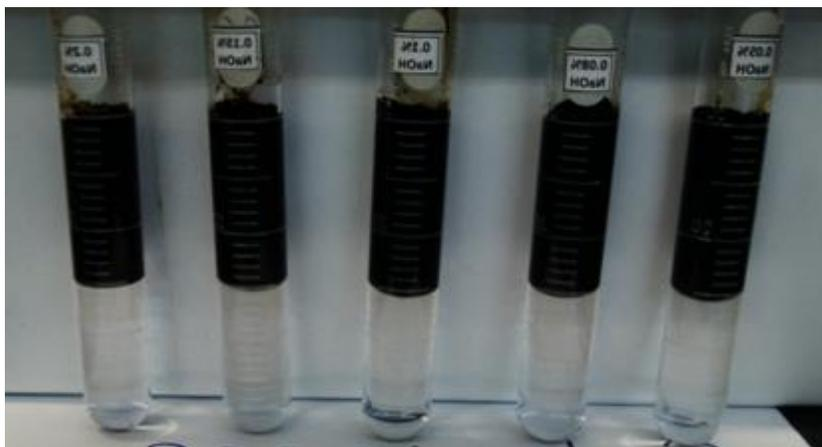
Figura 5.4. Comportamiento de fase de los sistemas crudo/ agua/ AMPS
