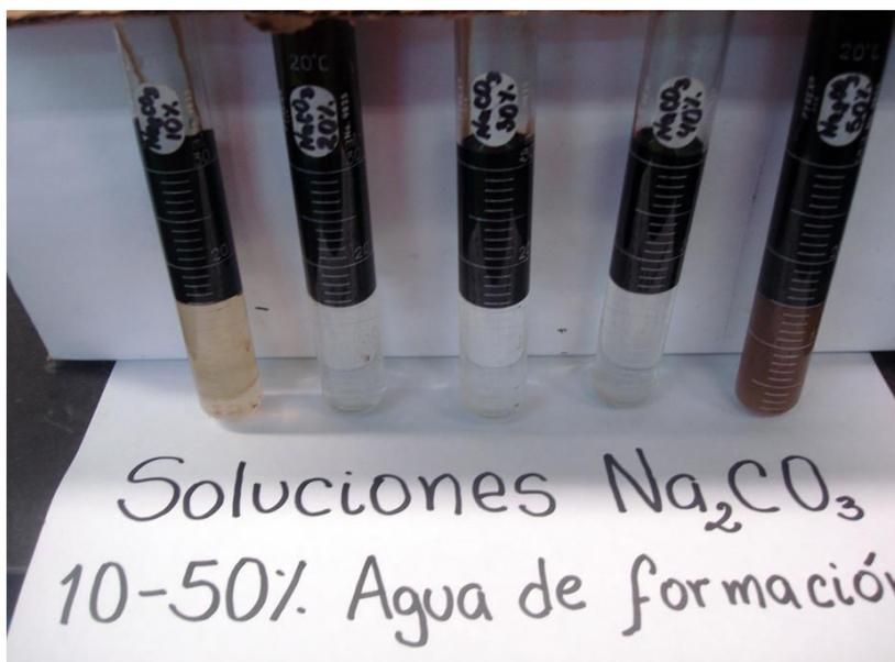
Figura 5.26. Comportamiento de fase de los sistemas Crudo/ Agua/ Na<sub>2</sub>CO<sub>3</sub>/ HPAM/ Mezcla de sales.
