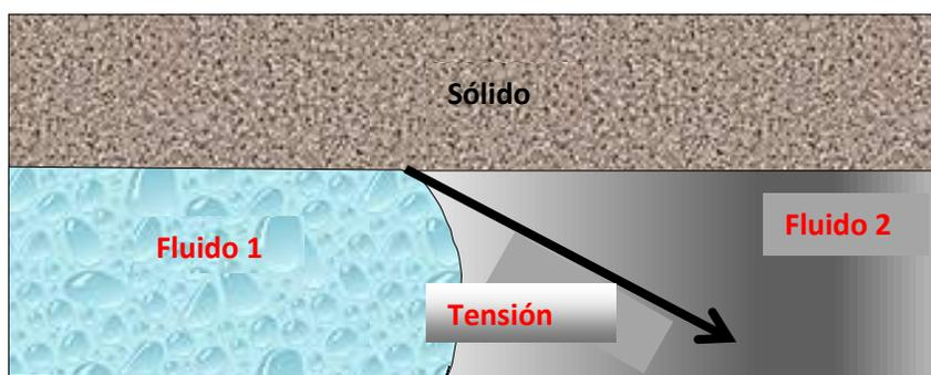
Figura 2.14. Línea de contacto trifásico. (Salager y Antón, 2005) (Mod. Irima, 2014).
