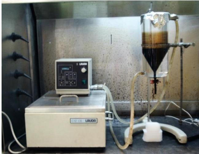
Figura 4.11. Ensamblaje para el llenado de crudo
