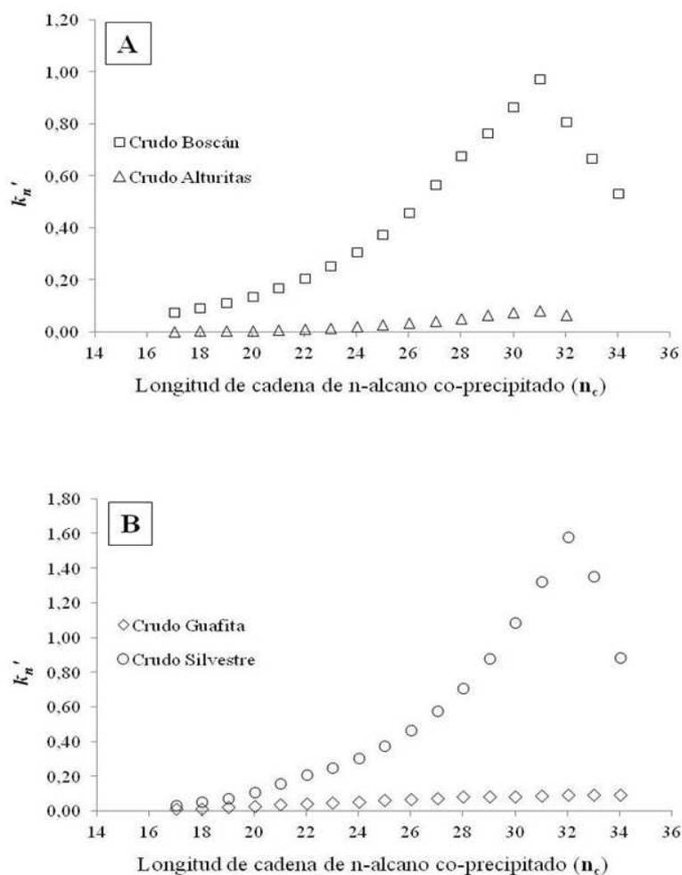
**Figura 2.** Factor de retención  $k_n'$  para  $n$ -alcanos co-precipitados con los asfaltenos de los crudos Boscán y Alturitas de la Cuenca del Lago de Maracaibo (A) y Guafita y Silvestre de la Cuenca Barinas-Apure (B).
