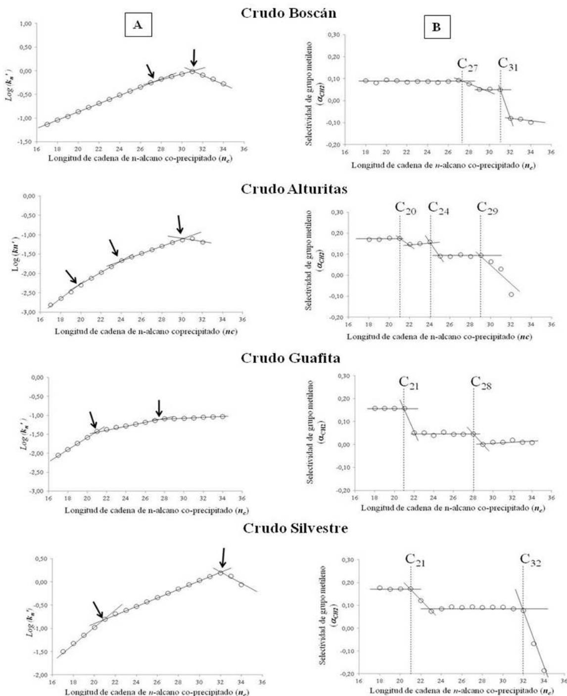
**Figura 3.** Variación de  $\text{Log}(kn')$  y de la selectividad de grupo metileno ( $\square CH_2$ ) en función de la longitud de cadena ( $n_c$ ) de los n-alcenos co-precipitados con los asfaltenos de los crudos Boscán, Alturitas, Guafita y Silvestre. La serie A corresponde a  $\text{Log}(kn')$  vs  $n_c$ . La serie B a  $\square CH_2$  vs  $n_c$ .
