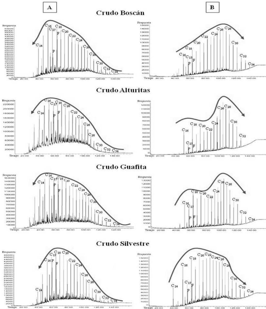
**Figura 1.** Distribución de *n*-alcanos en la fracción de saturados obtenida de los maltenos (A) y en la obtenida del material co-precipitado con los asfaltenos (B) de los crudos Boscán, Alturitas, Guafita y Silvestre. El enriquecimiento en compuestos *n*-alcanos de mayor o de menor MASA peso molecular está señalado por el sentido de las flechas. P= Pristano; F= Fitano.
