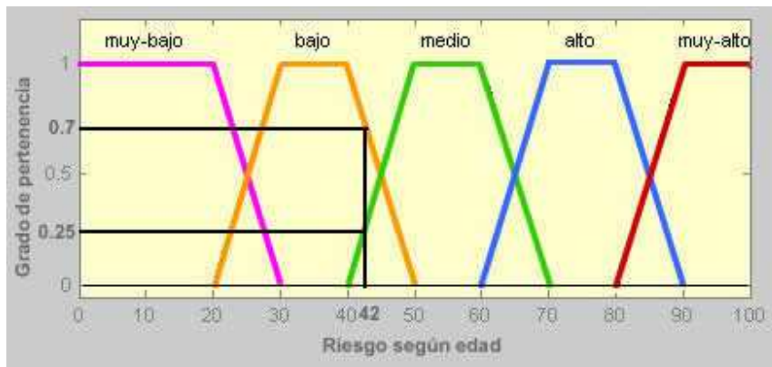
Figura 1.14. Grados de pertenencia asociados a los conjuntos difusos que contienen el valor x=42
