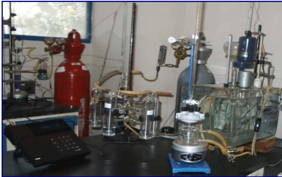
Figura 6. Esquema del sistema de medidas de emf (H). (a) vaso de reacción (100 mL) Metrohm EA 876-20, (b) pH -metro, (c) electrodos, (d) termostato de agua, (e) frascos lavadores N 2 , (f) bureta. 47
