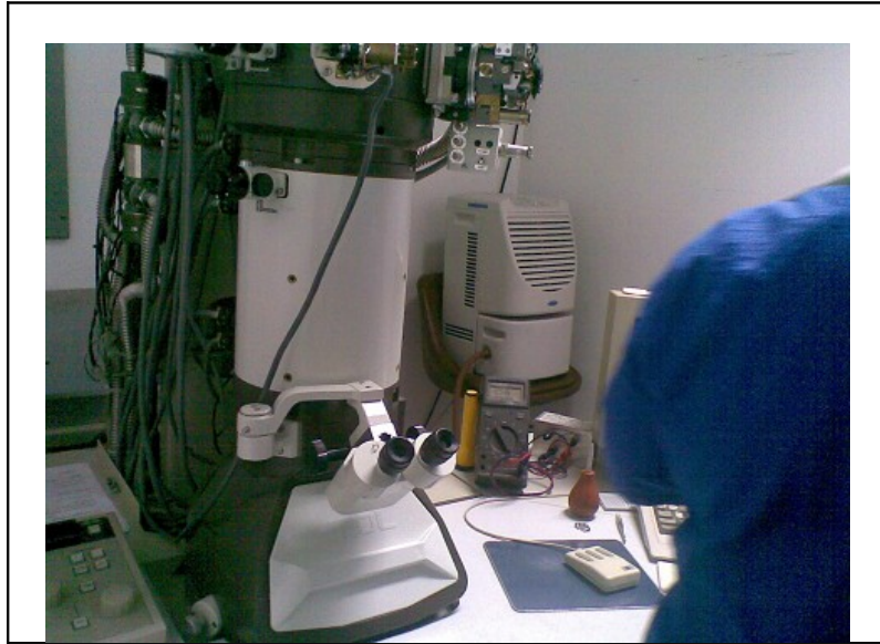
Figura 6. Microscopio Electrónico de Transmisión JEOL JEM-1220. Universidad Simón Bolívar. Grupo de Polímeros.
