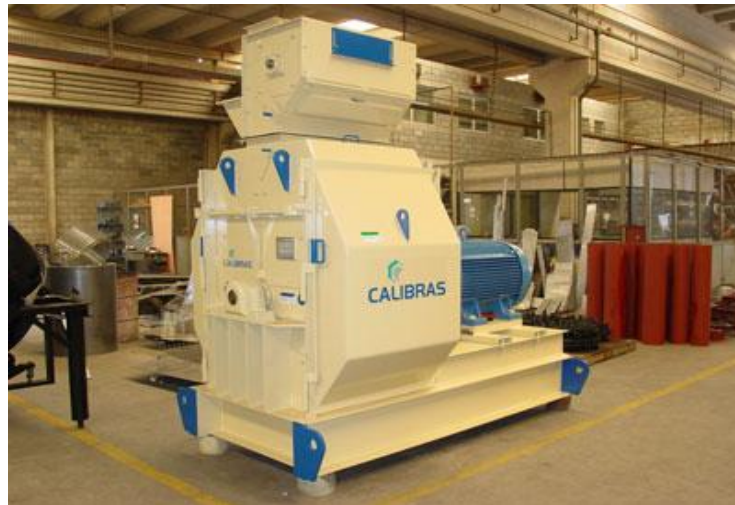
Figura 3. Molino de martillos con alimentador rotativo y placa magnética.
