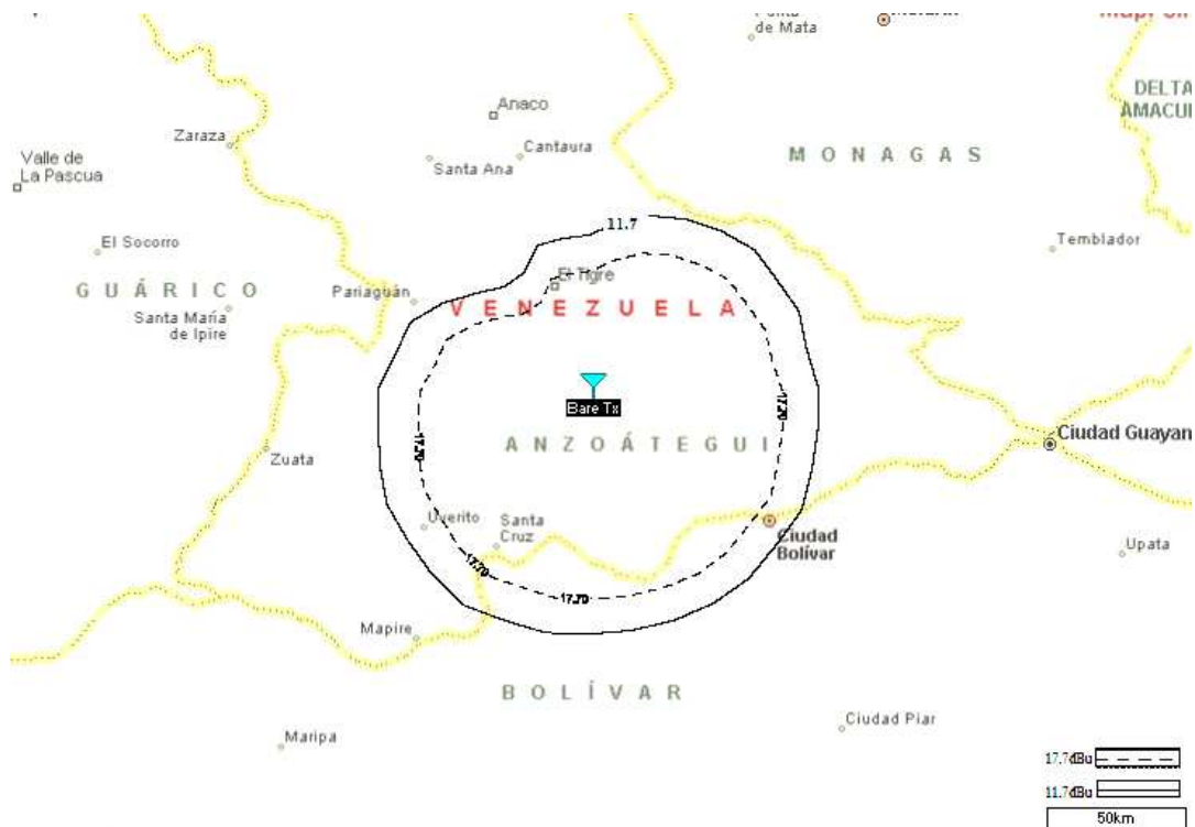
Figura 18. Contorno de Servicio(17.7dBu) y de Protección(11.7dBu) de la Estación Bare. Fuente: Autor.
