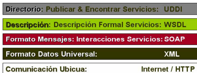
Figura N° 8. Pila de Servicios Web.
